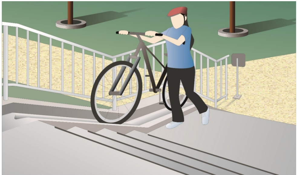
Rampa com guia lateral embutida
