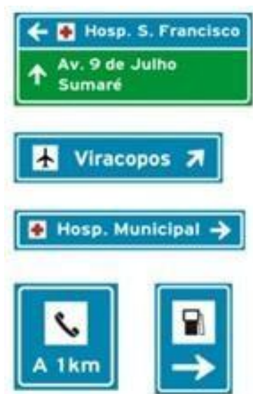
Figura 21 - Placas de Serviços Auxiliares
