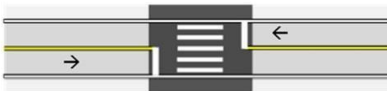
Figura 47 - Pintura de contraste na sinalização horizontal em pavimento de concreto
