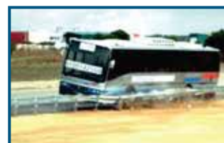
Ensaio TB 51 Ônibus 13.000 kg, a 70 km/h e 20°
