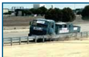
Ensaio TB 42 Caminhão 10.000 kg, a 70 km/h e 15°
