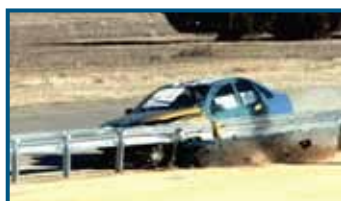
Ensaio TB 32 Carro 1.500 kg, a 110 km/h e 20°
